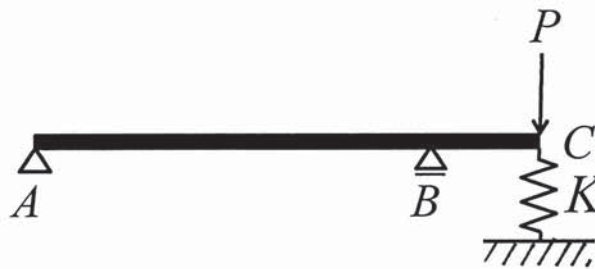
図2 バネを設置したはり
