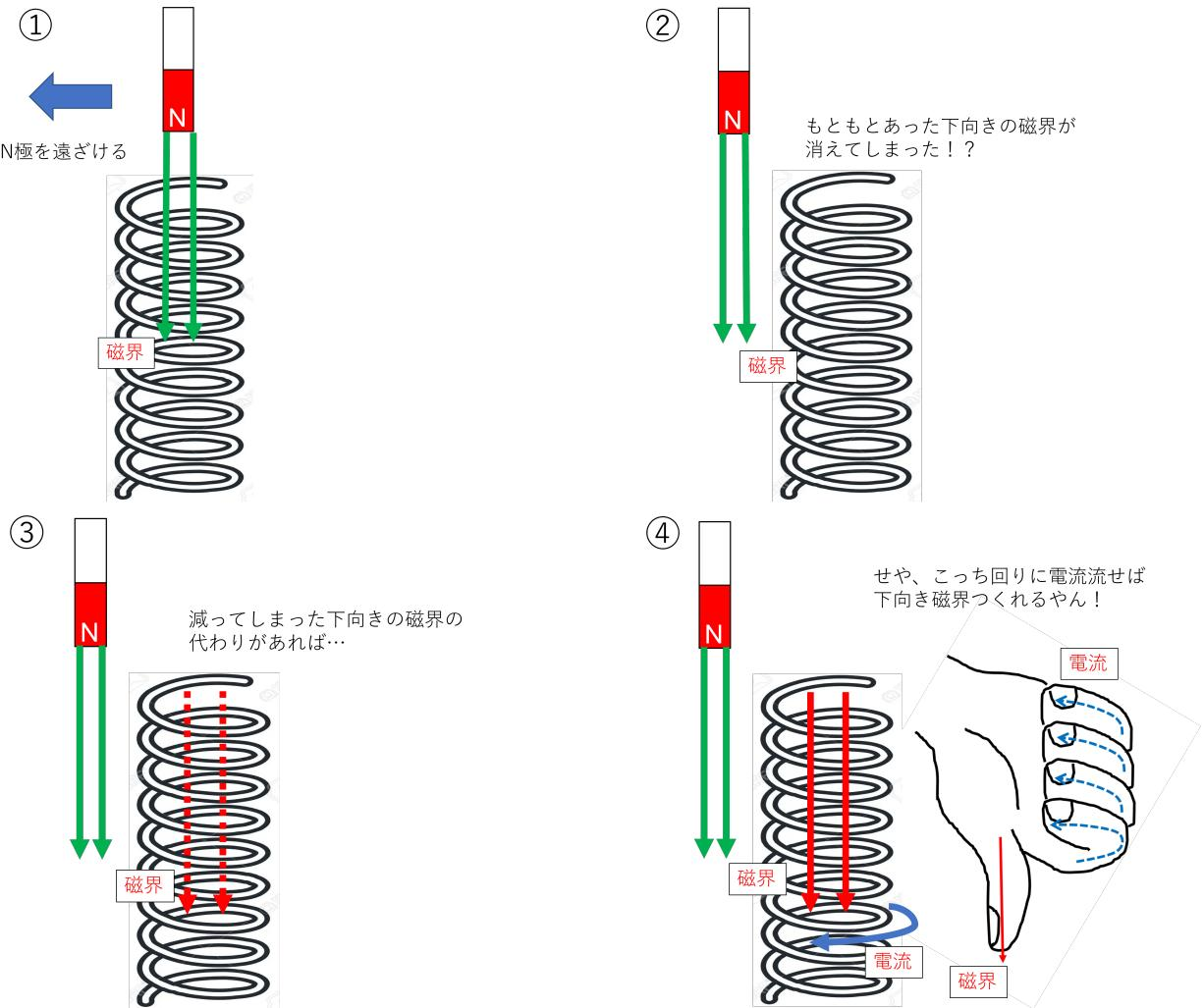
コイルは変化を嫌うから、磁界の変化を打ち消そうと電流を流す。したがって、棒磁石がコイルに近いけど全く動かしてないときは、磁界は発生しているが磁界の変化がないから電流が流れないことも理解できる気がする。
